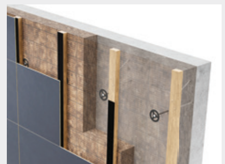
Thermisch geoptimaliseerde bevestigingswijze met afstandschroeven
