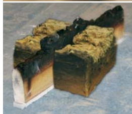
Brannpåvirkning av stenderverk med ROCKWOOL isolasjon etter 50 minutter
