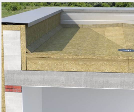
3. Įrengus termoizoliaciją, toliau klojama hidroizoliacinė stogo danga. Tam dažniausiai naudojama PVC membrana ir atliekamas šios dangos tvirtinimas prie pagrindo.
