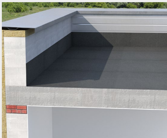
1. Ant lygaus, švaraus ir sauso gelžbetoninio pagrindo įrengiame garų izoliacijos sluoksnį iš tam skirtų plėvelių.
