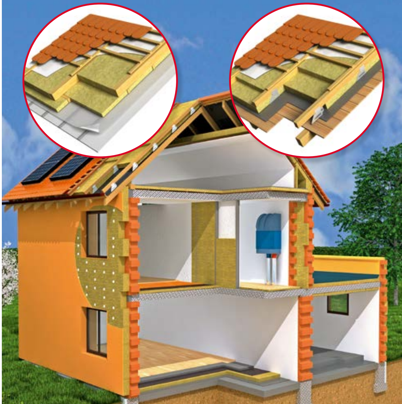
Zateplenie strechy medzi a pod krokvami
